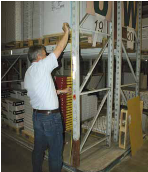
Abb. 6: Überprüfung der Fachhöhe
