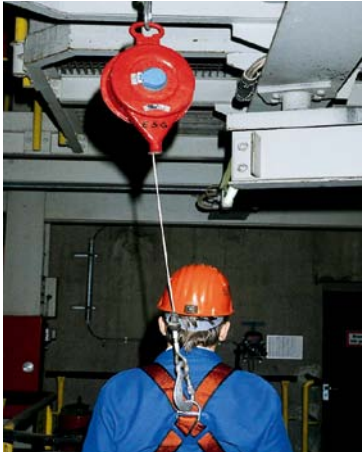
Bild 6: Beispiel eines Auffangsystems mit Höhensicherungsgerät
