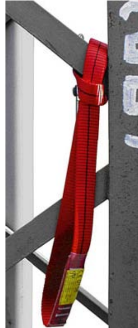
Bild 33: Beispiele für die Verwendung einer Bandschlinge als Anschlaghilfe
