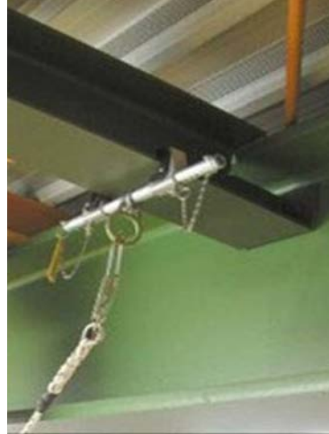
Abb. 14 Beispiele für Anschlageneinrichtungen der Klasse B – Bandschlinge, Trägerklemme
