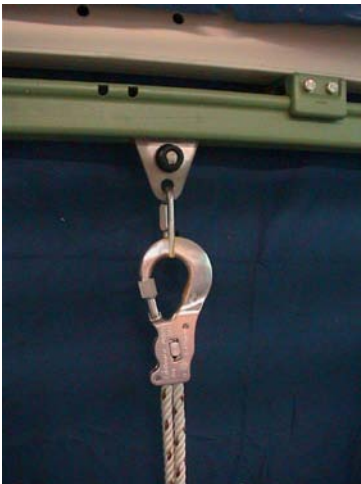
Abb. 17 Anschlageneinrichtung mit horizontaler Führungsschiene und beweglichem Anschlagpunkt
