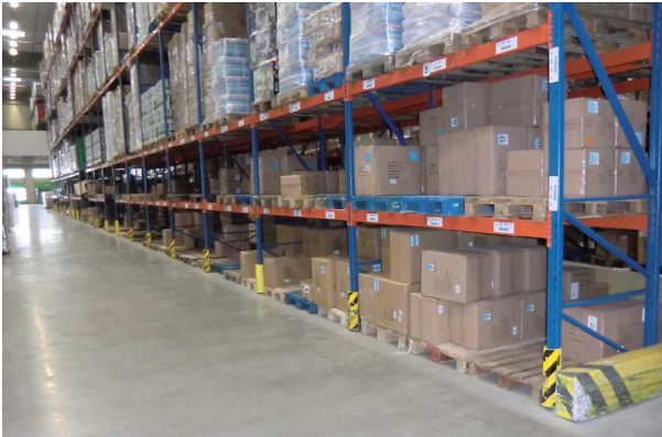
Abb. 19 Stützenschutz an allen Stützen
