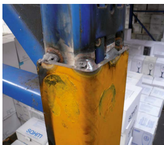
Abb. 11 Unfachmännisch geschweißte Stütze
