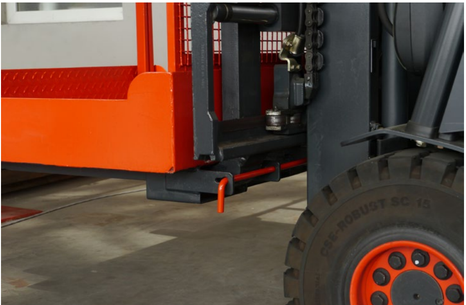
Abb. 2 Formschlüssige Befestigung der Arbeitsbühne
